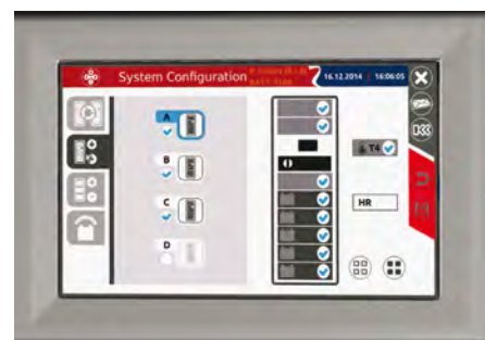
Сенсорный ЖК-экран MPW: удобное для пользователей отображение конфигурации и мониторинга ИБП.
